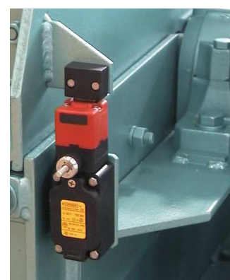
interrupteur de sécurité d'ouverture du casque
